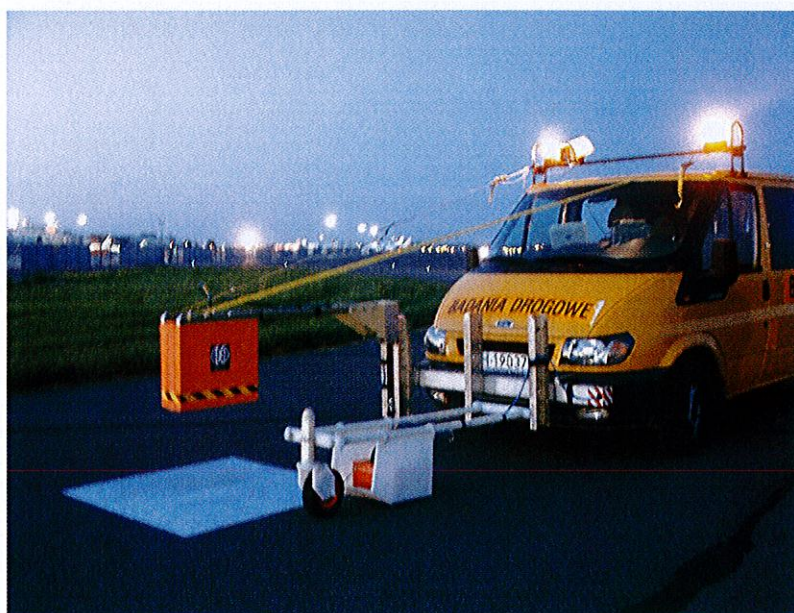
Rysunek 2.17 System pomiarowy z umieszczoną w wózku anteną typu ground-coupled o częstotliwości 400 MHz i umieszczoną na wysokości ok. 45 cm anteną typu horn o częstotliwości 1 GHz
